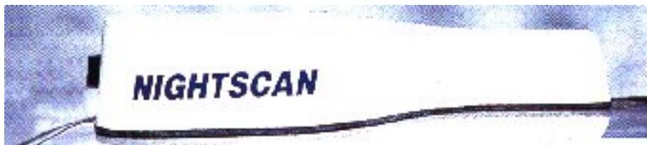
Le coffret de réception du NIGHTSCAN placé sur le toit du véhicule.
