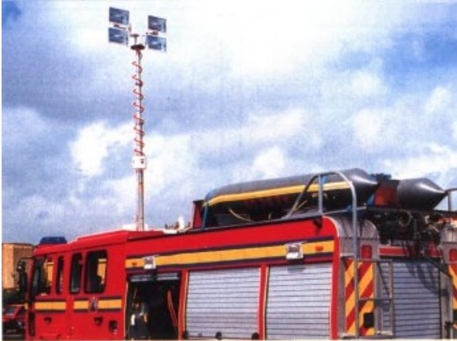
13 modèles différents, ils peuvent être équipés de 2 à 6 projecteurs lumineux. Ces projecteurs sont orientables en site et en azimut à l'aide de la télécommande.
