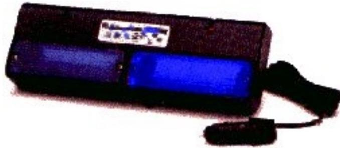
Ce feu particulièrement compact, 98 x 271 x 38 mm se présente sous la forme d'un boîtier rectangulaire équipé de deux sangles velcro afin de l'adapter au pare soleil d'origine. Son faible poids (410 gr.) ne gêne en aucun cas l'utilisation normale du pare soleil. Sur sa face principale sont incorporé deux feux stroboscopiques d'une puissance de 20 watts.
